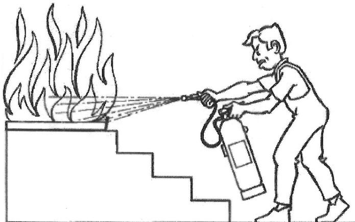
4. Dirigir el chorro a la base de las llamas con movimiento de barrido. En caso de incendio de líquidos proyectar superficialmente el agente extintor efectuando un barrido evitando que la propia presión de impulsión provoque derrame del líquido incendiado. Aproximarse lentamente al fuego hasta un máximo aproximado de un metro.
